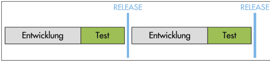
Abb. 1: Aufteilung von Entwicklungs- und Testaktivitäten bei wenigen großen Releases pro Jahr
